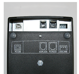
Złącza ukryte od spodu obudowy umożliwiają podłączenie szuflady na pieniądze i komputera
