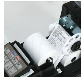
Szybki mechanizm drukujący wykorzystujący rolki papieru o długości 40m
