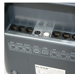
Złącza ukryte od spodu obudowy umożliwiają komunikację z komputerem (modemem), wagą, czytnikiem kodów kreskowych, szufladą na pieniądze, drukarką zamówień/monitoringiem, terminalem kart płatniczych, pracę w sieci LAN (w wersji 6.143 PLU)
