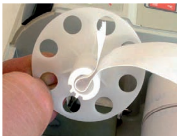
Rys. 2-2. Prawidłowy sposób zakładania taśmy papierowej na rolce zwijacza
